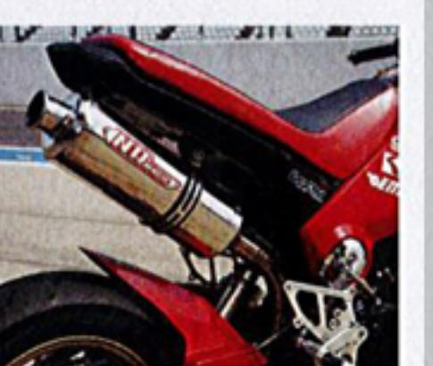
レースでの音量規定をクリアしながら、静か過ぎない低音域の効いたサウンドを奏でるNRマジック製マフラー。市販品なので、誰でも手に入れることができる。
